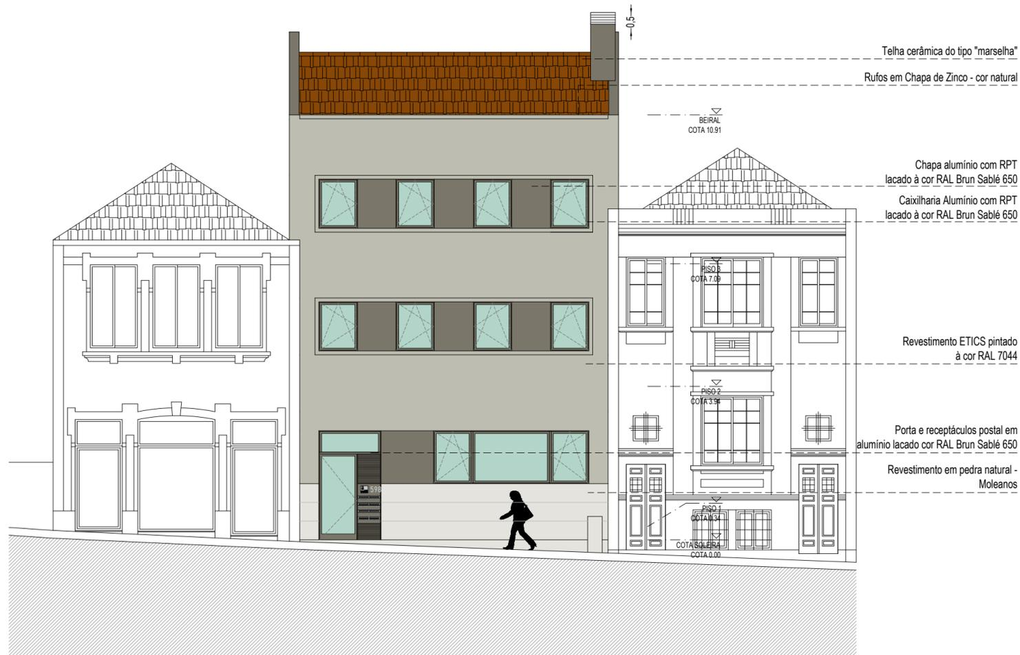
Telha cerâmica do tipo "marselha"
