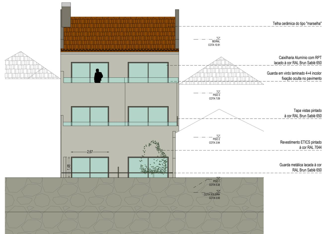
Telha cerâmica do tipo "marselha"
